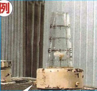
レベルゲージの左側にひび割れが確認できます。
