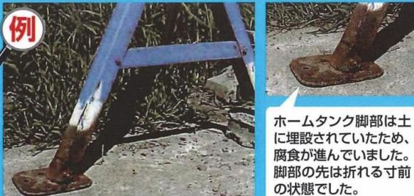
ホームタンク脚部は土に埋設されていたため、腐食が進んでいました。脚部の先は折れる寸前の状態でした。
