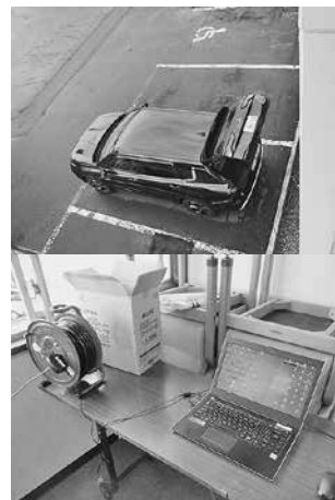
▲駐車場の町有車(PHEV車)から、対策本部のパソコンやテレビに給電し稼働させました。
