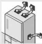
冷蔵庫ストッパーを用いて冷蔵庫の天板、または側板と壁をベルトで固定しましょう。
