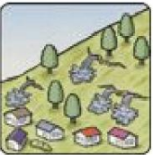
斜面から水がふき出す
